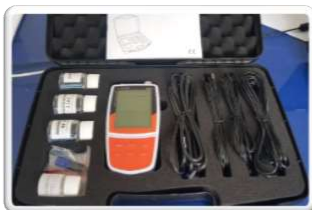
Maquinaria nueva para producir alimento balanceado (extrusora, mezcladora y secador): Equipo multiparamétrico para la medición de calidad de agua
